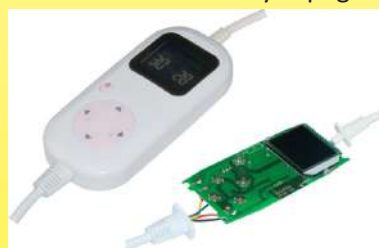
2019 Unidad de control para mantas térmicas con control de temperatura y pantalla digital a través de una sonda termistor incorporada en el área calentada (Colección Ultimheat)
