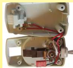
1995: Una manta térmica con medidor de potencia estadounidense, similar a la desarrollada más de 50 años antes por Cook en 1942. Vista exterior y vista de la bimetálica interna con un interruptor lento y resistencia anticipada. La única novedad en este modelo es que incluye un filtro de ruido (Colección Ultimheat)
